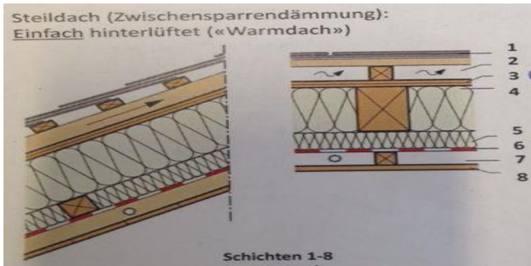
Couches d'un toit à forte pente
